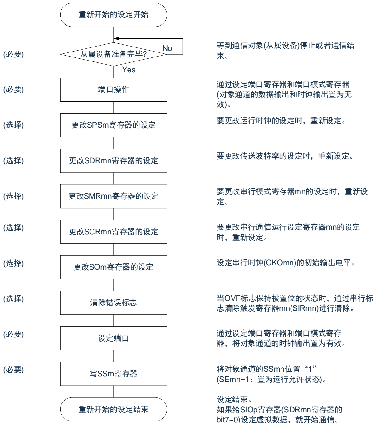
图12-34重新开始主控接收的设置步骤
