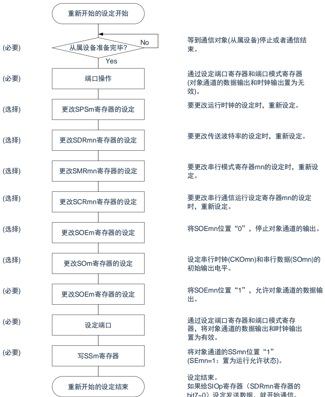
图12-26重新开始主控发送的设置步骤
