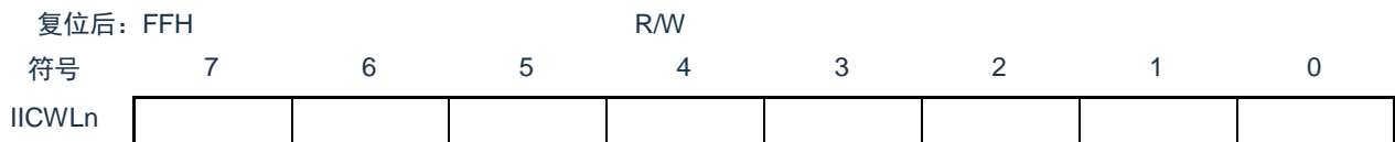
图13-10 IICA低电平宽度设置寄存器n (IICWLn) 的格式
