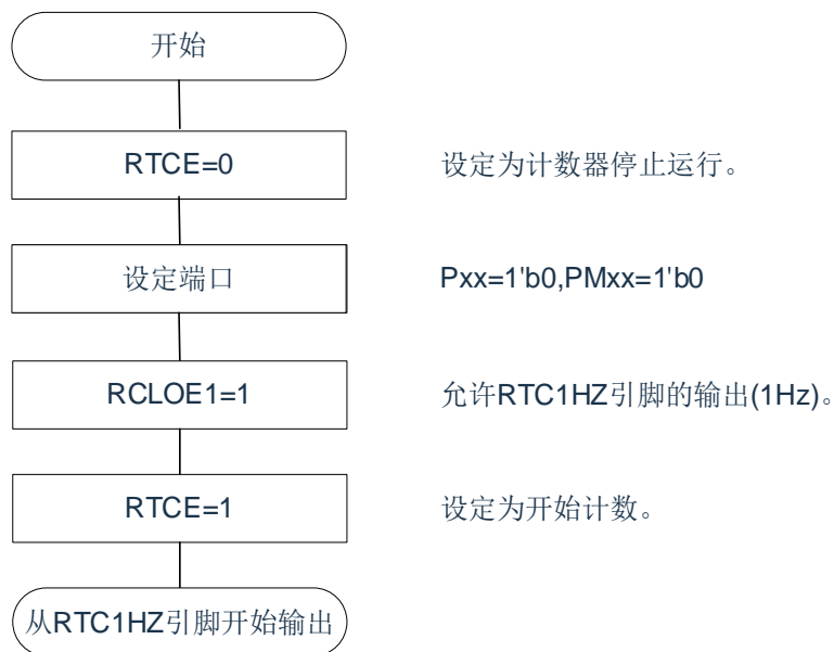
图6-22 1Hz输出的设置步骤
