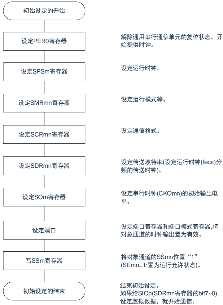
图12-32主控接收的初始设置步骤
